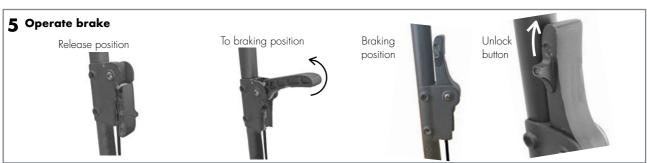
Parking brake - adjusting brake Feststellbremse - Abstellung Bremse Parkeerrem - afstellen rem
